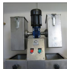
Figura 4: Caja Pfost, primer ensayo de durabilidad de los piensos compuestos.
