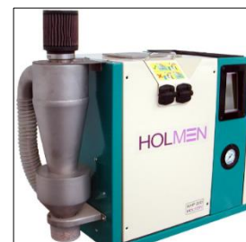
Figura 5: Medidor Holmer, segundo ensayo de durabilidad de los piensos compuestos.
