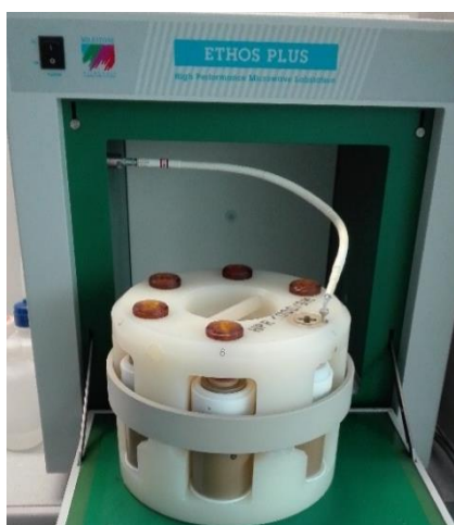
Ilustración 4. 8:Horno de digestión
