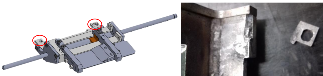
Figura 2.60: Problema de rotura de patillas.
