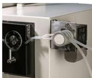
Cambio automático del disolvente puro al producto sin cambio manual de los tubos. Preferiblemente utilizado con el mando a distancia (incl. en el B-290 Advanced).
