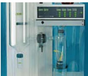
En caso de no disponer de ninguna tapa y trabajar con productos inflamables o tóxicos, el telón de seguridad es una alternativa segura. Fácilmente desmontable, las láminas posibilitan el control y la manipulación de las piezas de vidrio durante el proceso (incl. en el B-290 Advanced).
