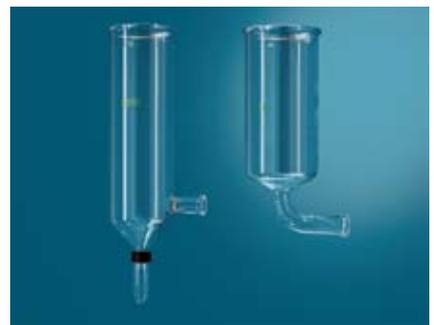
Dos salidas diferentes del cilindro de vidrio permiten optimizar la explotación de cada proceso. El cilindro de salida lateral está especialmente indicado para productos acuosos de difícil secado, mientras que el segundo tipo de cilindro, con geometría de salida vertical, ofrece ventajas para los disolventes orgánicos.
