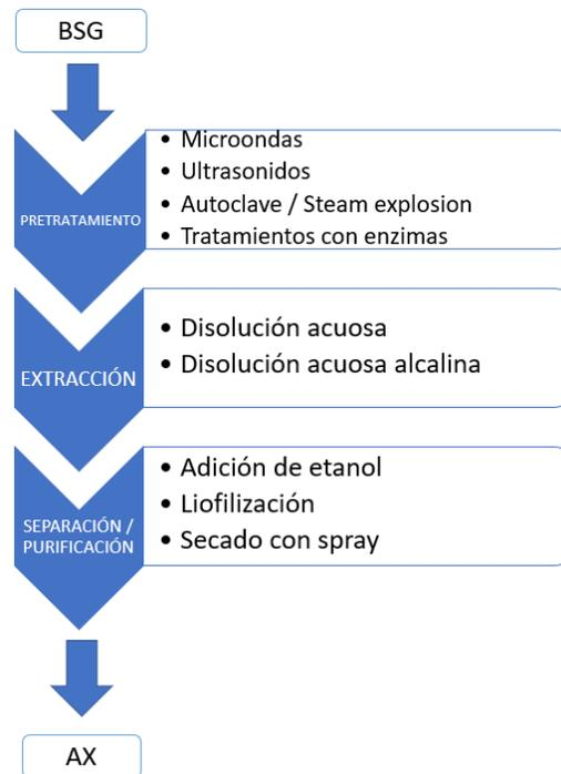
Figura 9. Diagrama de bloques del proceso de obtención de AX a partir de BSG. (FUENTE: elaboración propia)
