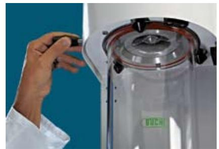
El montaje de las piezas de vidrio es particularmente elegante y fácil. El cilindro de vidrio se instala en un sólo movimiento manual con una palanca de bloqueo.
