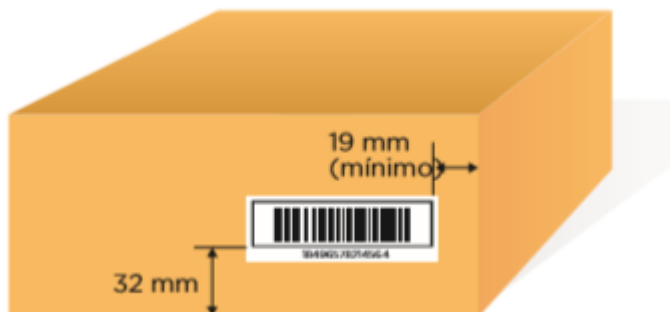
A. Figura 4.9. Ubicación de etiquetas GS1 – 128 en cajas formato.
