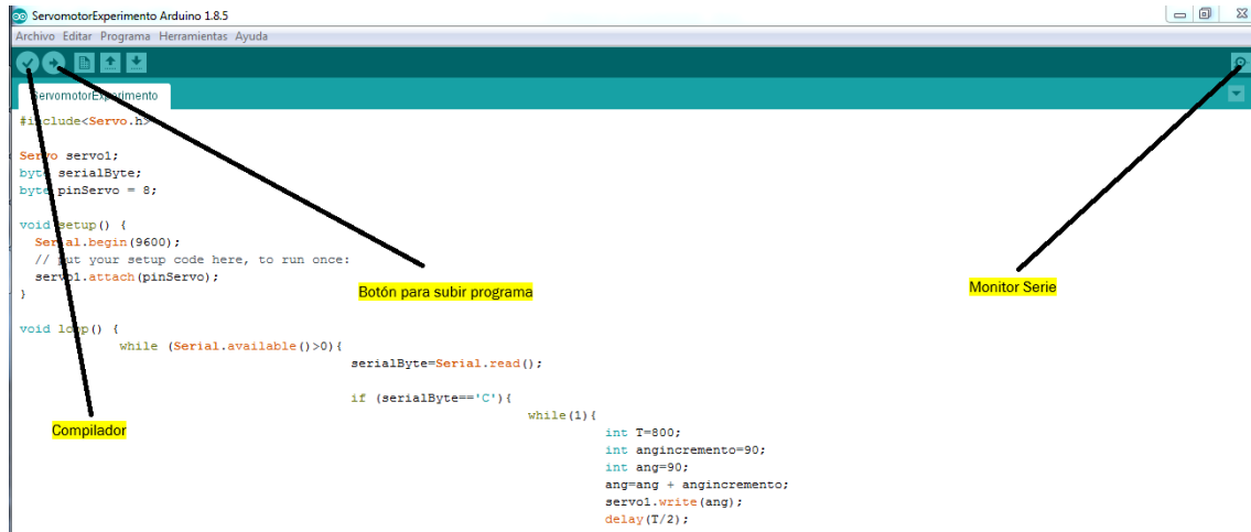
Ilustración 36 Guía de funcionamiento del interface Arduino.
