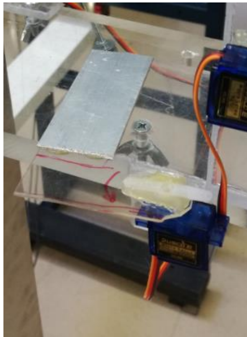
Ilustración 21 Servomotor de amortiguamiento del péndulo (servomotor 2).
