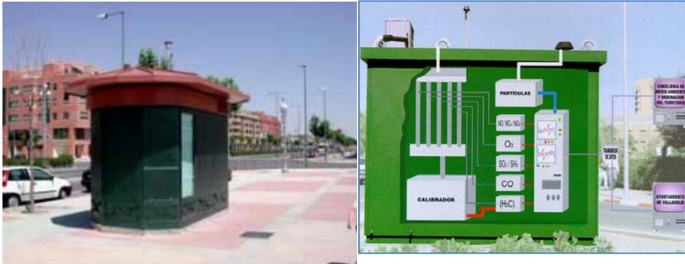
Figura 4. Imagen exterior y plano interior de una estación de medida (Tomada de informes del Ayuntamiento de Valladolid y de la Junta de Castilla y León).
