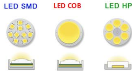
Fig. 2.12.- Apariencia de los distintos montajes.
