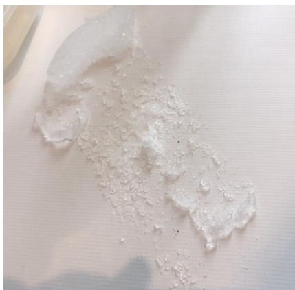
Figura 22. Aplicación del poliacrilato de sodio como nieve artificial.
