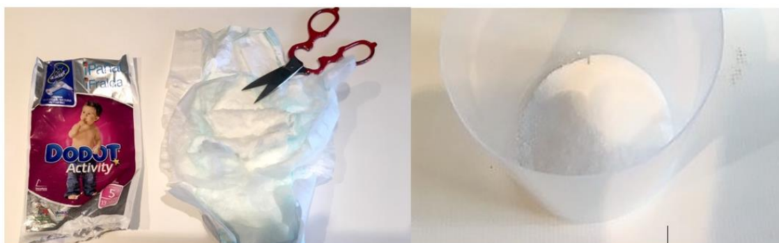
Figura 17. Proceso de apertura de un pañal y extracción del poliacrilato de sodio.
