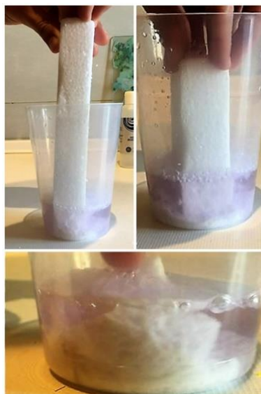
Figura 25. Introducción del poliexpan en acetona. “Desaparece”.
