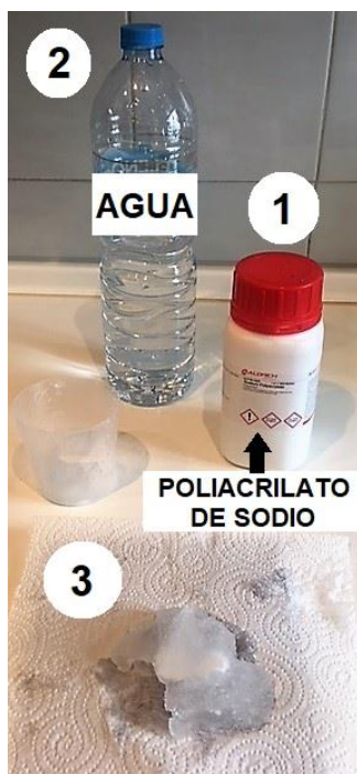
Figura 20. Resumen de los pasos seguidos en el experimento: "Un polímero absorbente. Poliacrilato de sodio".
