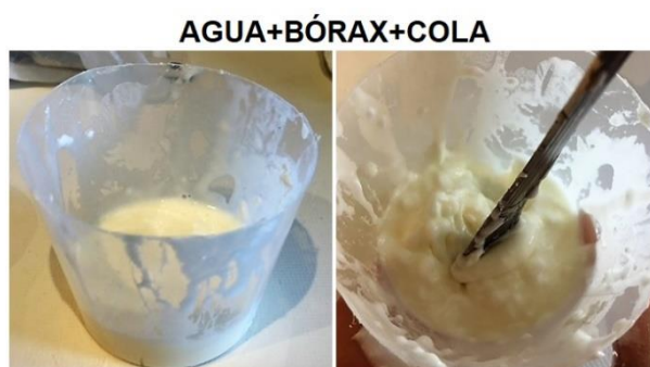
Figura 6. Solución diluida de cola con una pequeña cantidad de solución sobresaturada de bórax.
