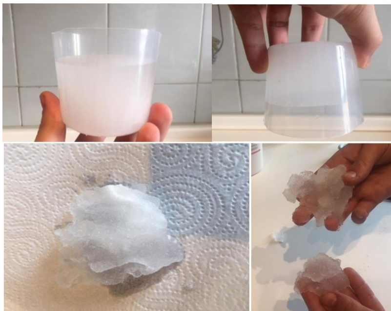
Figura 16. Gel cristalino que se forma al absorber el poliacrilato de sodio el agua.
