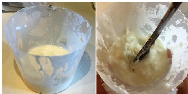
Figura 8. Solución diluida de cola con una gran cantidad de solución sobresaturada de bórax.
