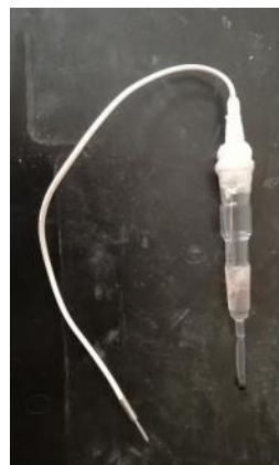
Figura 21: Electrodo de Ag/AgCl-KCl
