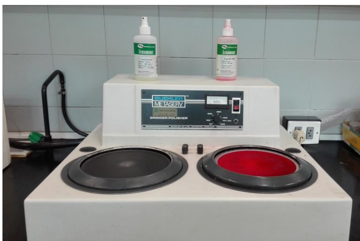
Figura 10: Discos de Pulido y lubricantes de diamante suspendido
