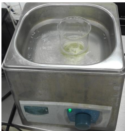
Figura 19: Disolución en baño de ultrasonidos
