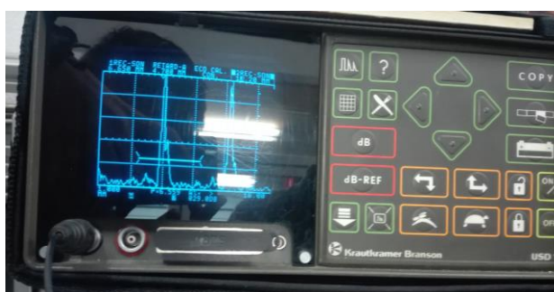
Figura 15: Señal de rebote ultrasonidos
