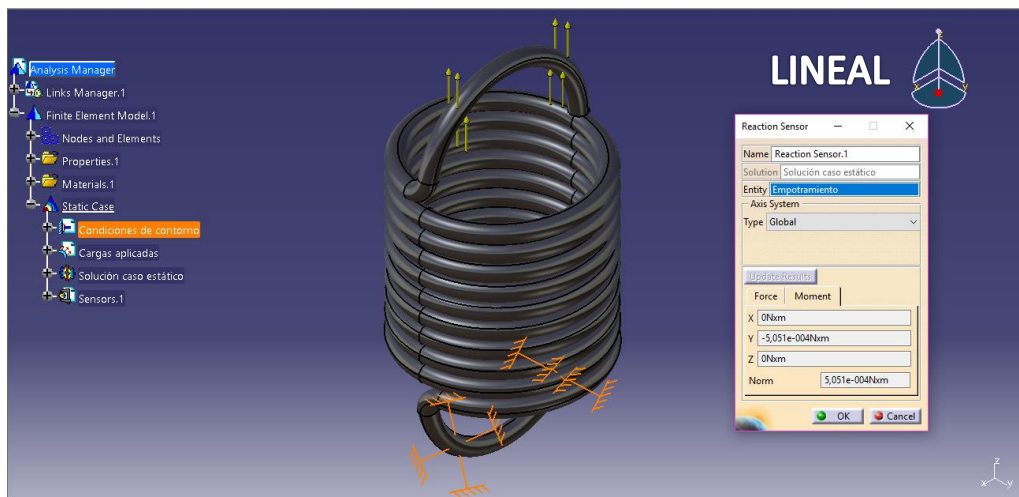
Figura 4.92 Reacción de los momentos en modelo lineal
