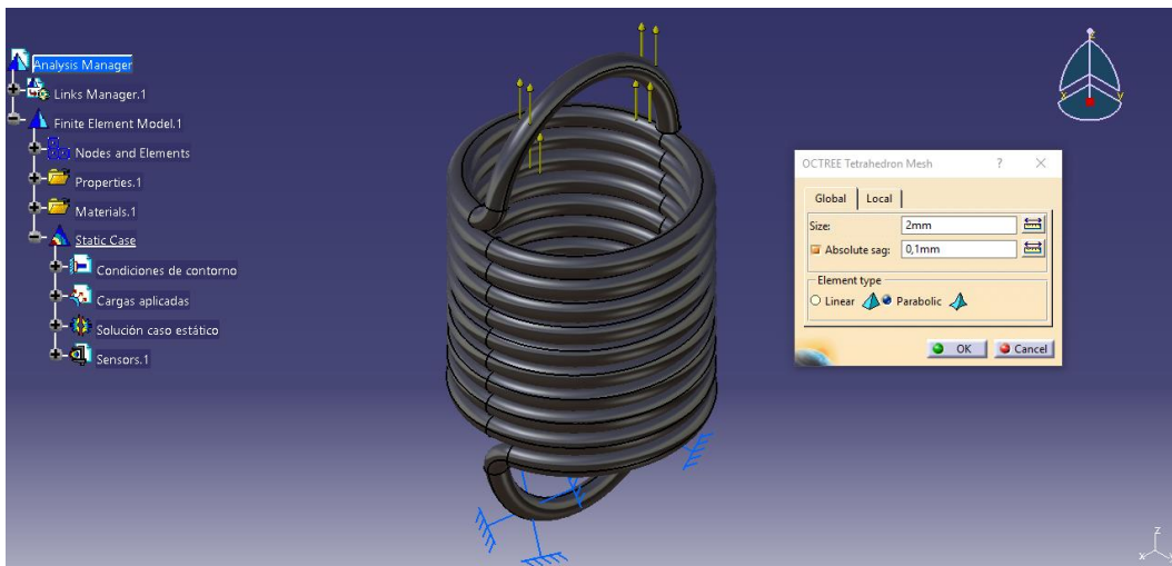
Figura 4.72 Mallado parabólico del resorte
