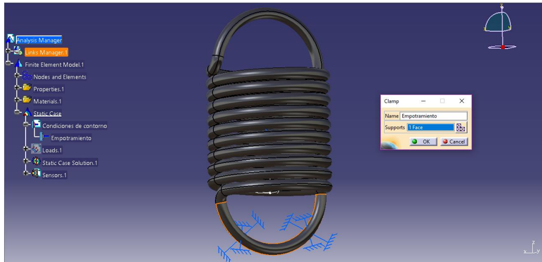
Figura 4.73 Condición de contorno
