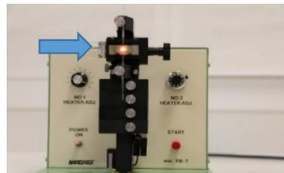
*Figura 19. Estirador de pipetas. La flecha indica la resistencia eléctrica.*
