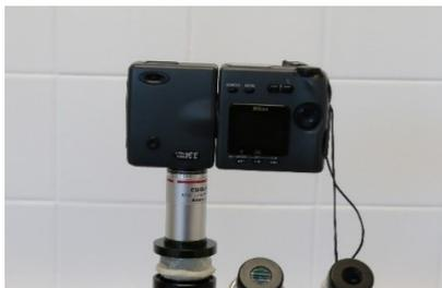
*Figura 16. Cámara acoplada a estereomicroscopio NIKON COOLPIX 990*
