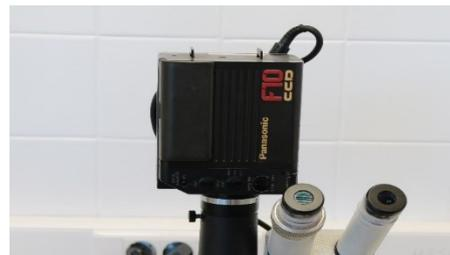
*Figura 17. Cámara acoplada a estereomicroscopio PANASONIC F10 CCD*
