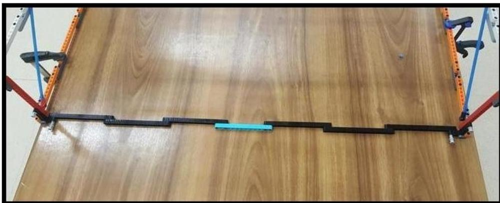
Figura 6.3: Viga bi-articulada con la que se atan los pórticos.
