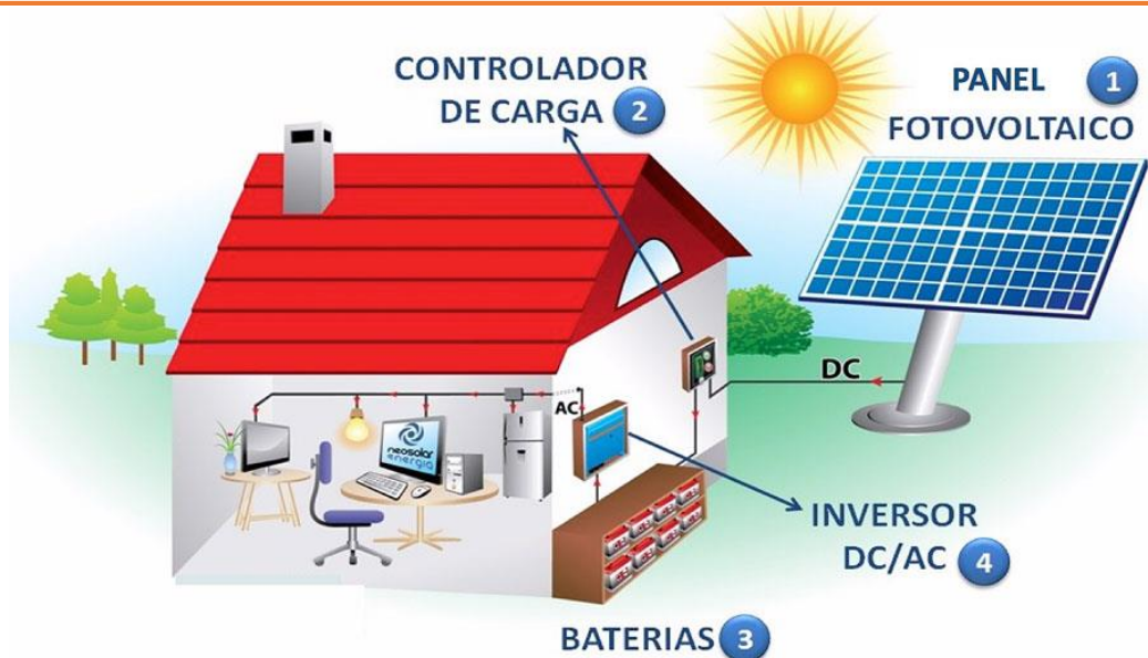
Figura 8: Instalación solar fotovoltaica aislada
