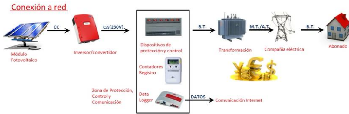
Figura 58: Instalación solar fotovoltaica conectada a la red
