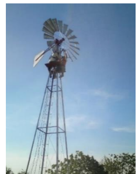
Figura 17: Aerogenerador multipala para el bombeo de agua
