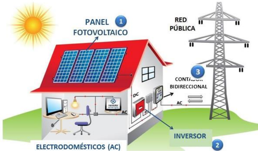
Figura 9: Instalación solar fotovoltaica conectada a la red
