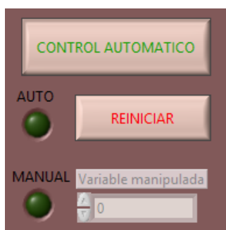
Figura 4.21. Interfaz usuario selector de modo manual o automático con habilitación de la variable manipulada en modo manual.
