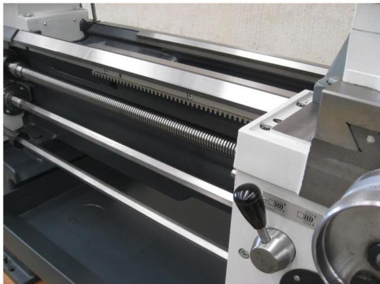
*Detalle de la bancada con las guías, los ejes laterales y la cremallera.*
