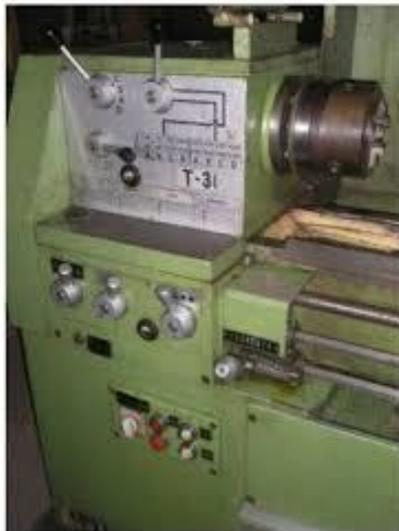
*Cabezal de un torno.*
