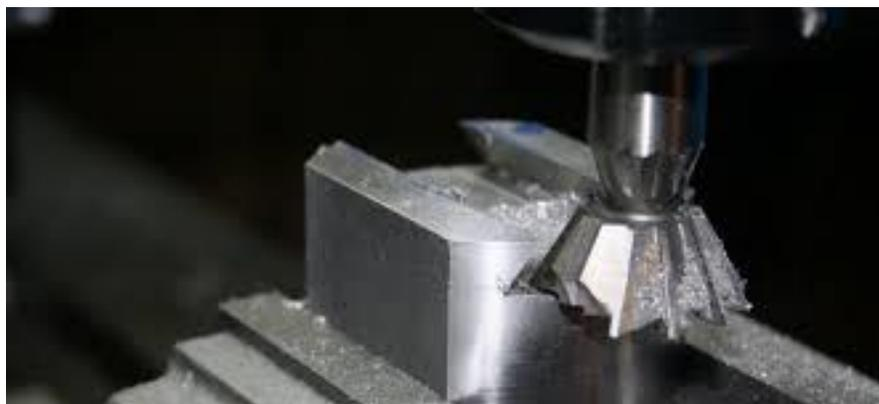
*Fresado angular de una pieza.*
