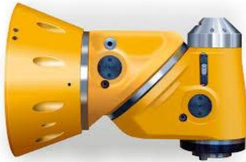
*Cabezal universal para fresadora.*
