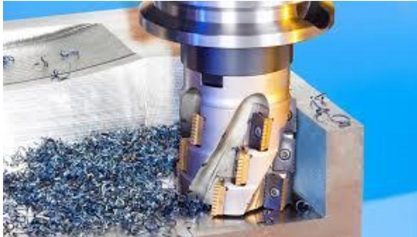
*Fresado lateral de una pieza.*
