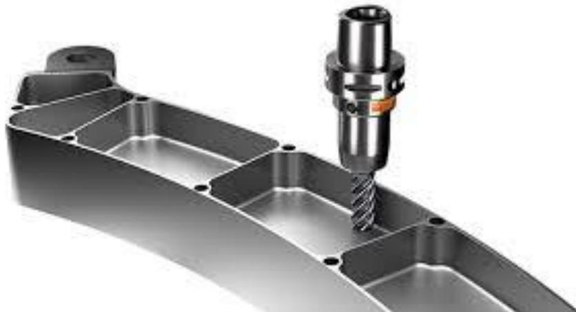
*Fresado plano de una pieza.*
