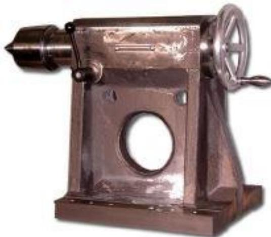
*Contracabezal de un torno paralelo.*
