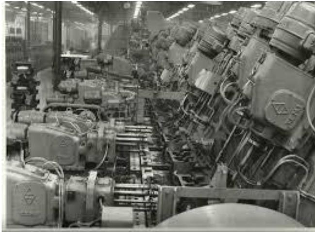
*Máquina transfer con mecanismo de correa sin fin.*
