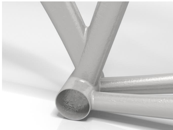
Figura 27. Detalle del aspecto de las soldaduras
