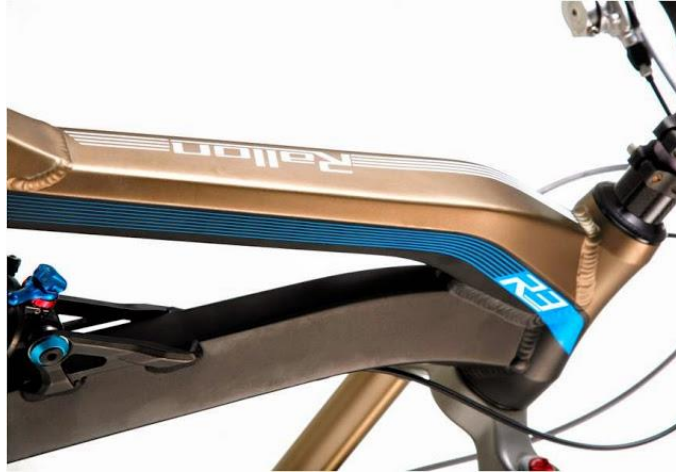
Figura 18. Cuadro de aluminio hidroconformado. Fuente: http://www.biket3ch.com/2014/05/como-se-fabrica-un-cuadro-de-bicicleta.html
