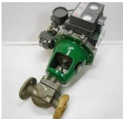
Figura 9: Vista externa de la válvula neumática
