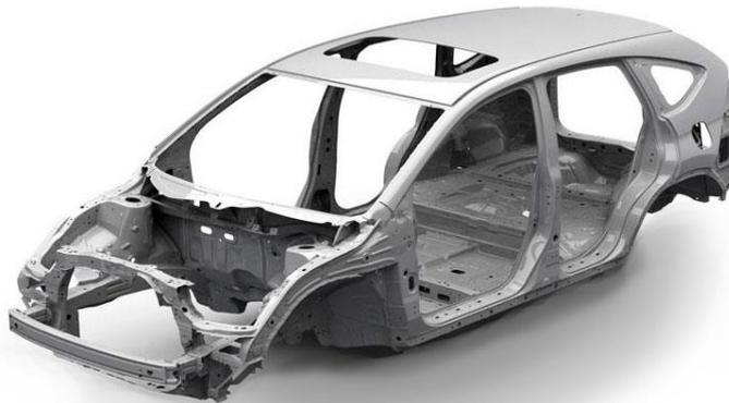
*Fig.16 Carrocería autoportante*
