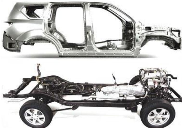
*Fig.17 Carrocería con chasis independiente
