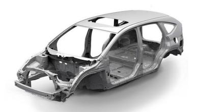
Fig.16 Carrocería autoportante [Fuente: cesvimap]
