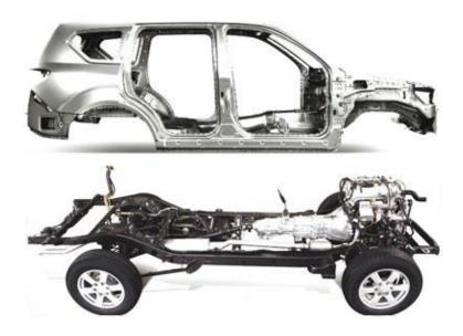
Fig.17 Carrocería con chasis independiente [Fuente: cesvimap]
