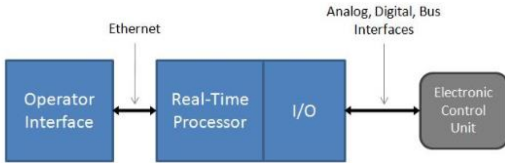
Fig. 2. Diagrama de bloques de un sistema de pruebas HIL
