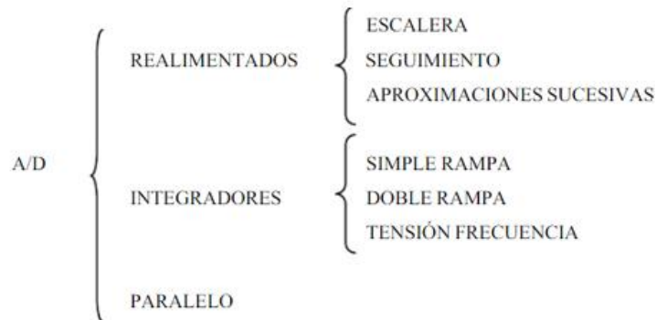
Fig. 18. Esquema tipos de ADC según su arquitectura
