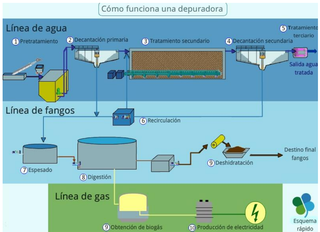
Figura 9. Esquema proceso EDAR. Fuente: http://elauladehistoria.blogspot.com.es/2016/04/como-funciona-una-estacion-depuradora.html
