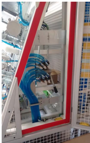
Figura 2: Acceso a la conexión neumática lateral
