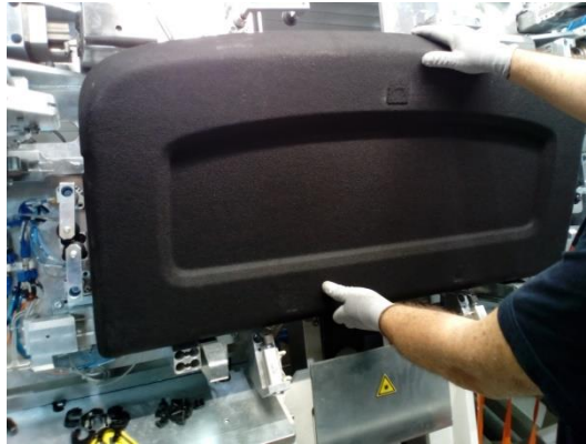
Figura 43: Método de carga de bandeja
