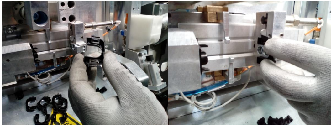
Figura 42: Método de carga de omega interior
