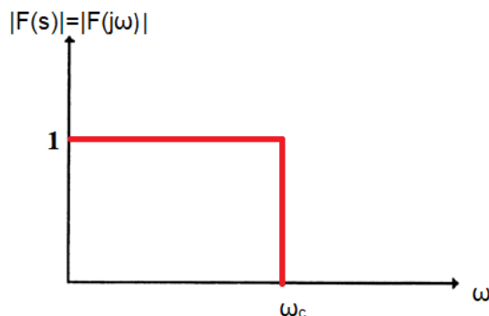
Ilustración 26: Función ideal de transferencia en cadena cerrada del modelo de regulación óptimo cuantitativo [4]
