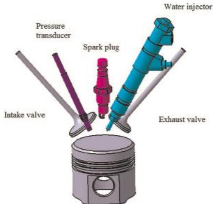
Figura 46: Representación en 3D del sistema de inyección directa en el cilindro. [18]
