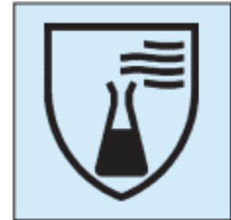
Figura 5. Pictograma para el calzado resistente a productos químicos
