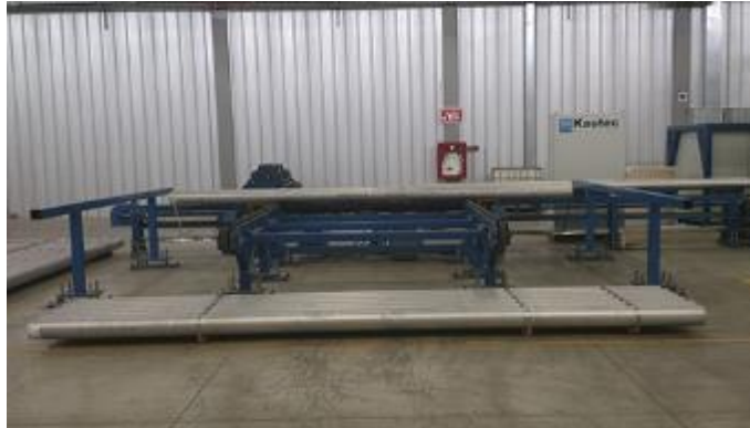
Figura 11: Sistema para cargar los tochos de 7m
