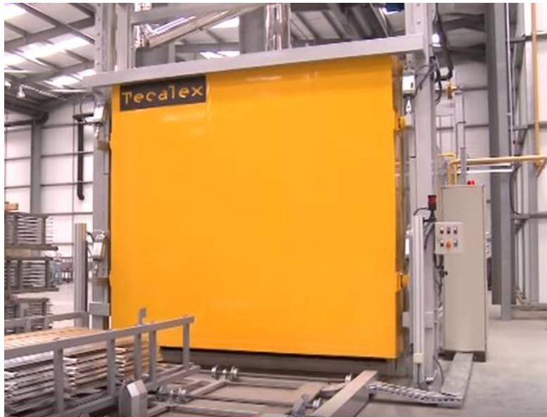
Figura 32: Barrera de protección térmica
