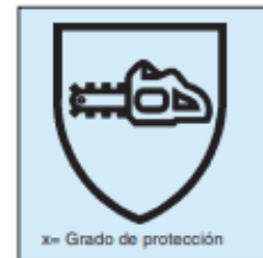
Figura 2. Pictograma para el calzado con resistencia al corte por sierra de cadena
