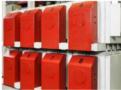
Figura 13: Estufas para precalentamiento de matrices
