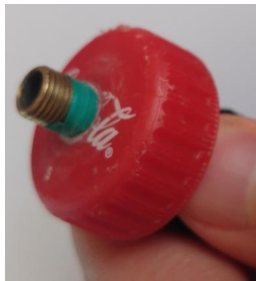
Figura 3 Tapón ya perforado con la tobera (válvula) de salida colocada
