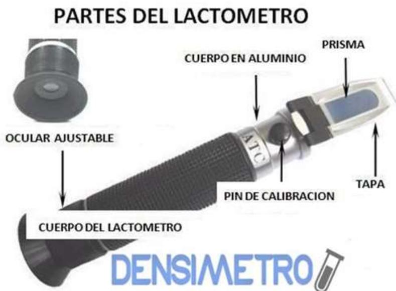
Ilustración 2. Partes de un lactómetro
