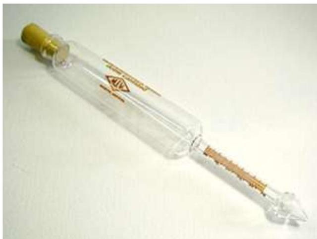
Ilustración 7. Butirómetro
