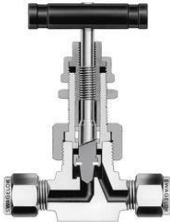
Figura. 3.5 Esquema de una válvula de aguja Fuente: : www.valvias.com/tipo-valorva-de-aguja.php
