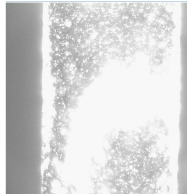
Figura. 4.5 Ejemplo de excesiva iluminación de las partículas
