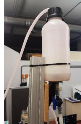
Figura. 3.7 Depósito de descarga
