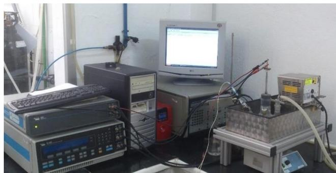
Figura 18. Equipo empleado en las mediciones de ruido electroquímico
