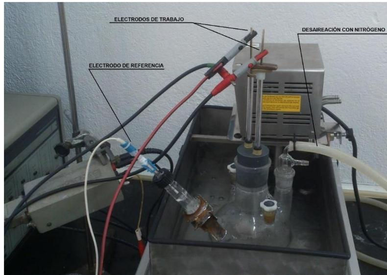
Figura 17. Montaje de la celda electroquímica
