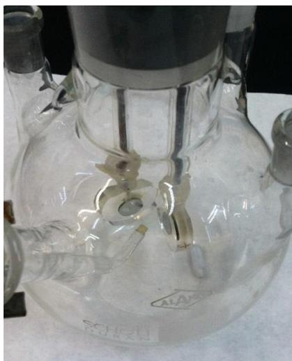
*Figura 16. Montaje de las probetas en el matraz*
