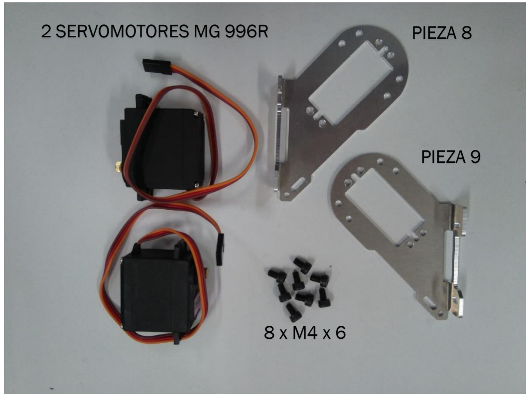
FIGURA 18. COMPONENTES PASO 5
