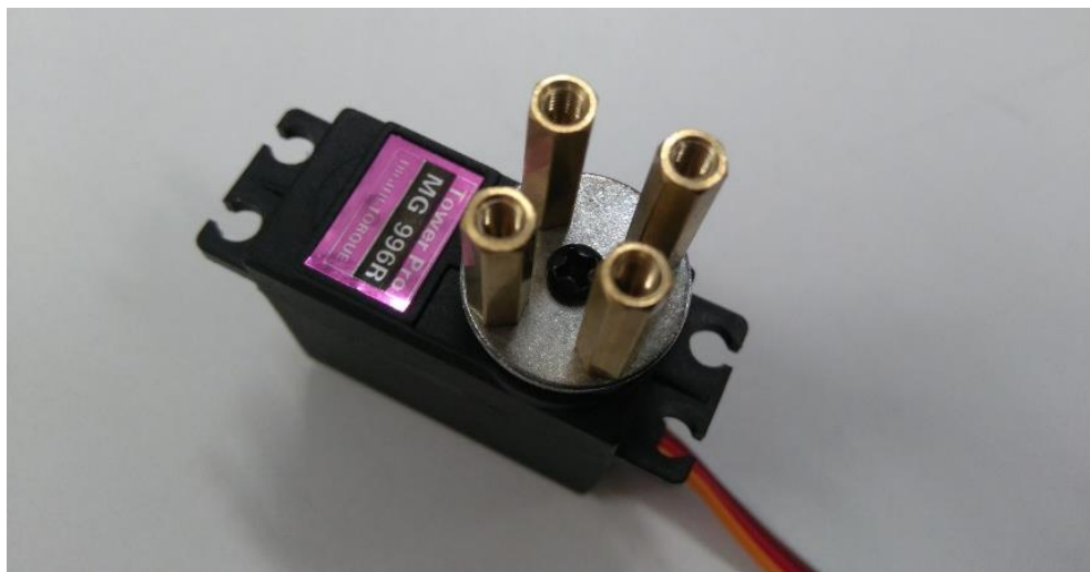
FIGURA 52. CONEXIÓN DE LA BRIDA AL SERVO
