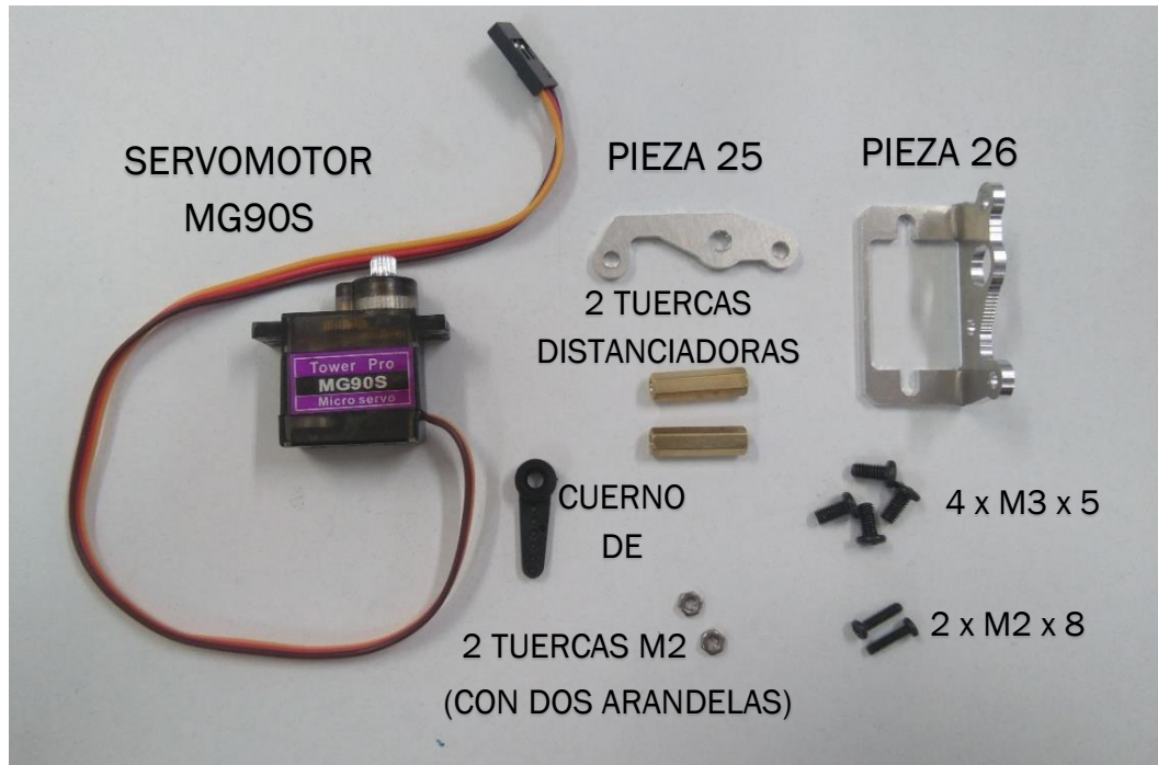
FIGURA 61. COMPONENTES PASO 15
