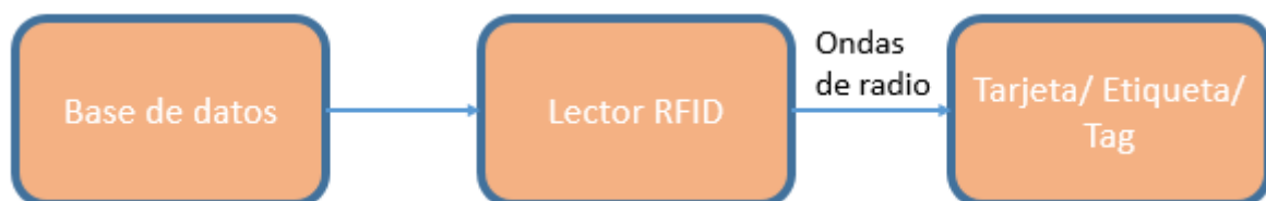
Figura 3.3 Funcionamiento RFID (Fuente: elaboración propia)
