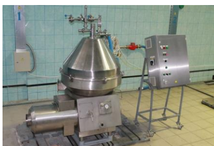
Figura 4: Desnatadora para ajustar el contenido graso de la leche
