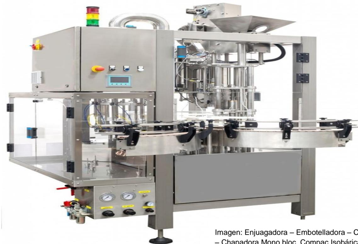
Imagen: Enjuagadora – Embotelladora – Carbonatadora – Chapadora Mono bloc Compac Isobárica 5.
