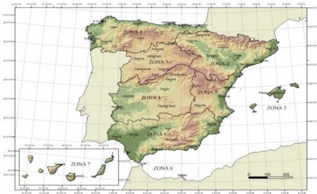
Figura 2. Mapa Nivel inverna (CTE Documento básico Seguridad estructural y acciones en la edificación) Mediante estos datos se han generado las cargas por viento y nieve.
