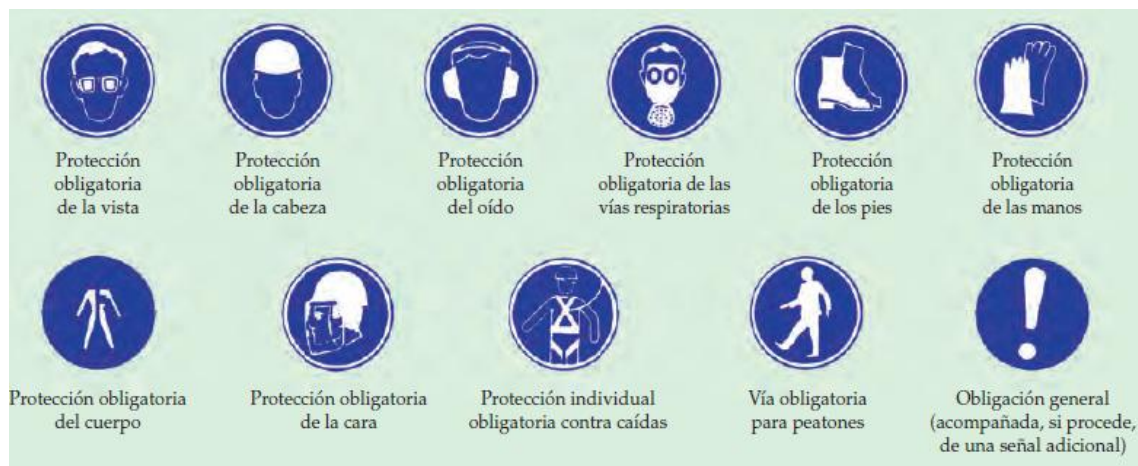
Figura 4. Señales de obligación según Guía Técnica sobre Señalización de Seguridad y Salud en el Trabajo
