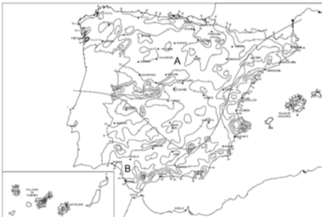
Imagen 1: Mapa de isoyetas y zonas pluviométricas (Fuente: Anexo B del HS-5 del CTE)
