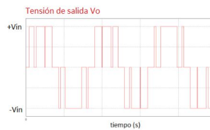
Fig. 2.44. Resultado de la modulación unipolar, tres niveles a la salida
