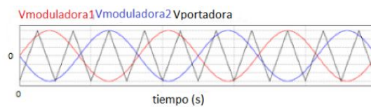
Fig. 2.40. Señales auxiliares en PWM senoidal unipolar
