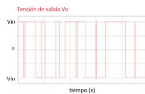
Fig. 2.32. Resultado de la modulación bipolar, dos niveles a la salida
