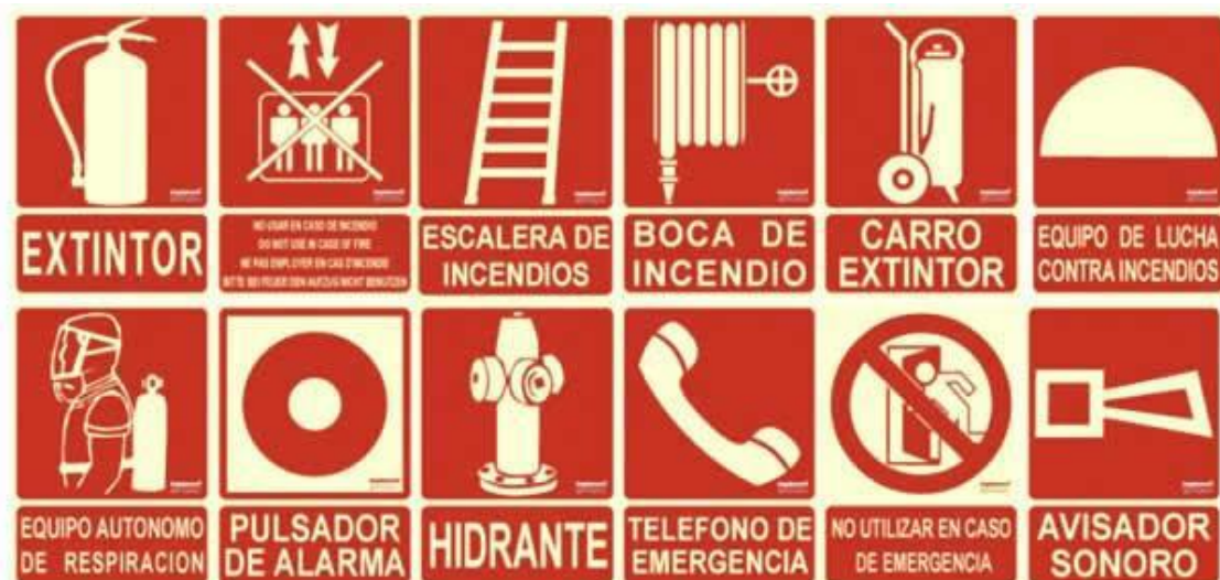
Imagen A11.2. Señalización de los medios de protección contra incendios
