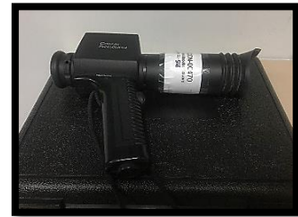
Figura 4 Colvard instrumento de medida del diámetro pupilar.
