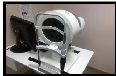
Figura 5 Galilei G4 sistema basado en una doble cámara de Scheimpflug, en un disco de plácido y en una cámara frontal.
