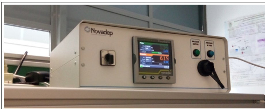
Figura 11: Panel de lectura y control del sistema de filtración
