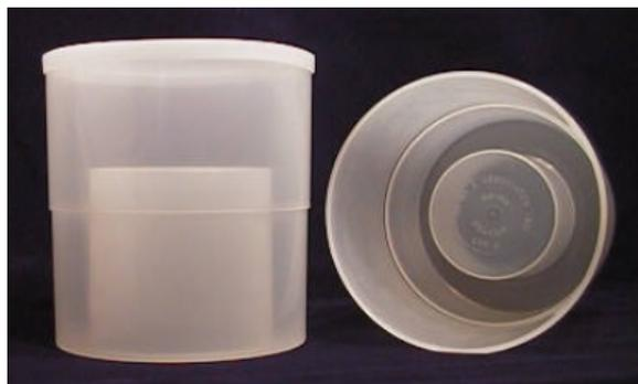
Figura 4.1: Recipiente marinelli utilizado en la recalibración del cóctel.
