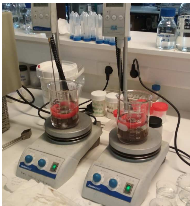
Figura 9.- Detalle extracción S-L en placas calefactoras con termómetro y agitación (Fisherbrand)
