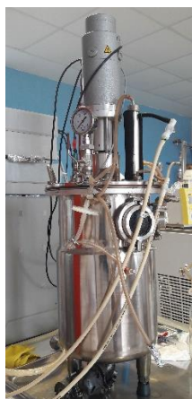
Imagen 16 Fermentador (de 15L). Imagen realizada por la autora del trabajo.
