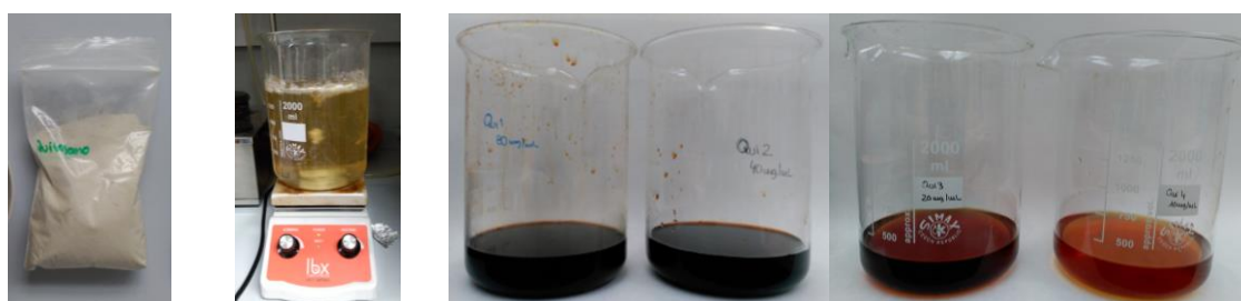
Figura 7. De izquierda a derecha: Quitosano en polvo; Solución de ácido acético al 2% y quitosano en agitación; Solución de oligómeros de quitosano de concentraciones 80, 40, 20 y 10 mg/ml.
