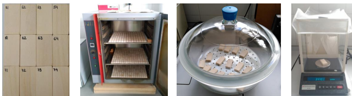
Figura 5. De izquierda a derecha: Probetas lijadas y numeradas; estufa con las probetas del ensayo; desecador con probetas en estado anhidro; balanza de precisión.
