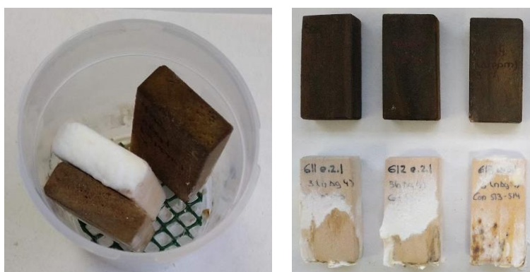
Figura 30. Probetas tratadas con una concentración de nanoplata de 5 ppm y probeta control no tratada en medio a las 12 semanas de la inoculación del hongo (izquierda); Probetas tratadas con una concentración de nanoplata de 20 ppm (arriba) y probetas control no tratadas tras 12 semanas de la inoculación del hongo (derecha).
