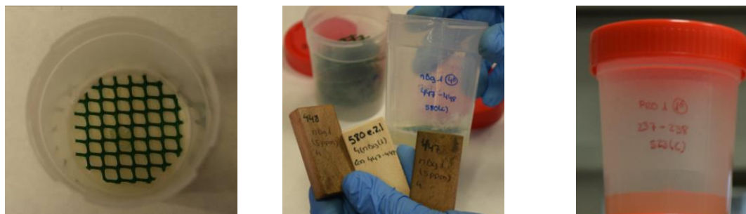
Figura 18. De izquierda a derecha: recipiente inoculado con T. versicolor con soporte plástico para evitar el contacto entre las probetas y el medio de cultivo; Probetas tratadas con la misma concentración y tratamiento junto con una probeta control situada en medio; recipiente de cultivo para las probetas tratadas 237 y 238 con propóleo de concentración I junto con el control 523 correspondiente al primer muestreo.
