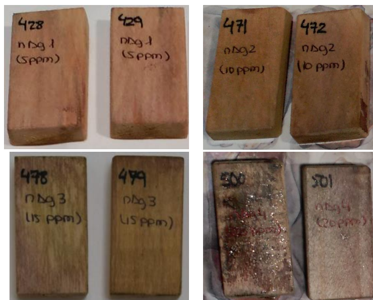
Figura 31. De izquierda a derecha, arriba y abajo: Probetas tratadas con 5, 10, 15 y 20 ppm de nanoplatas tras el periodo de estabilización en condiciones de laboratorio durante una semana.
