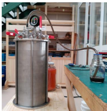
Figura 14. Introducción del tratamiento de quitosano de concentración 20 mg/ml (izquierda); manguera de presión conectada a llave de introducción/salida de presión y manómetro (derecha).
