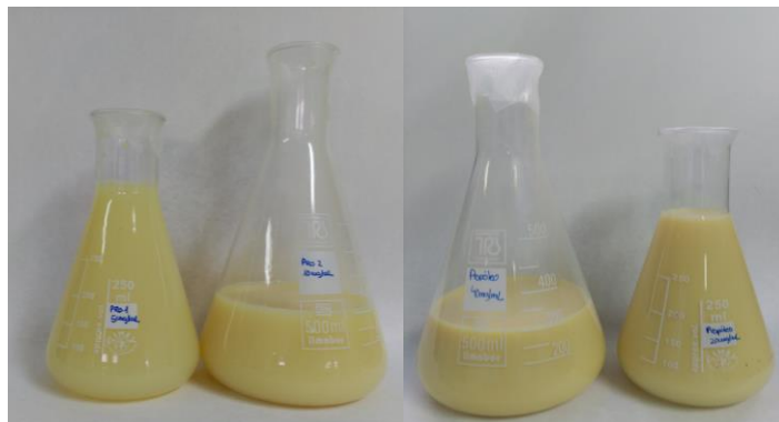
Figura 9. Soluciones de propóleo obtenidas por dilución de la concentración inicial de 96,4 mg/ml. De izquierda a derecha: 5 mg/ml; 10 mg/ml, 20 mg/ml y 40 mg/ml.
