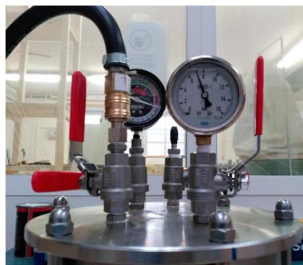
Figura 14. Introducción del tratamiento de quitosano de concentración 20 mg/ml (izquierda); manguera de presión conectada a llave de introducción/salida de presión y manómetro (derecha).
