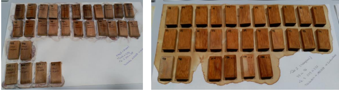
Figura 15. De izquierda a derecha: Probetas tratadas con solución de nanoplata 10 ppm; probetas tratadas con quitosano 40 mg/ml.
