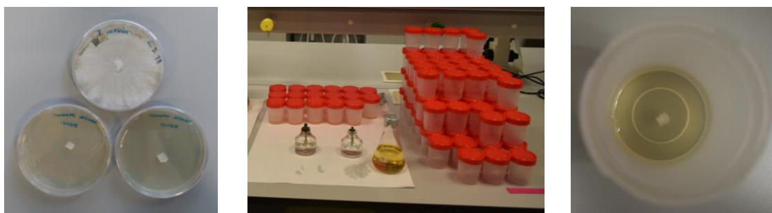
Figura 17. De izquierda a derecha: Aislado de T. versicolor y dos nuevos cultivos en placa Petri; dispersión del medio en los recipientes de cultivo mediante esterilización del ambiente con mecheros Bunsen; recipiente de cultivo inoculado con un cubo de agar con T. versicolor .
