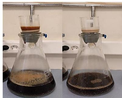
Figura 4. Crisoles con mosto (izqda.) y crema (drcha.) ubicados sobre sistema de filtración
