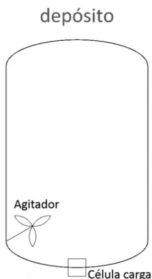
Figura 7. Partes de un depósito de almacenamiento
