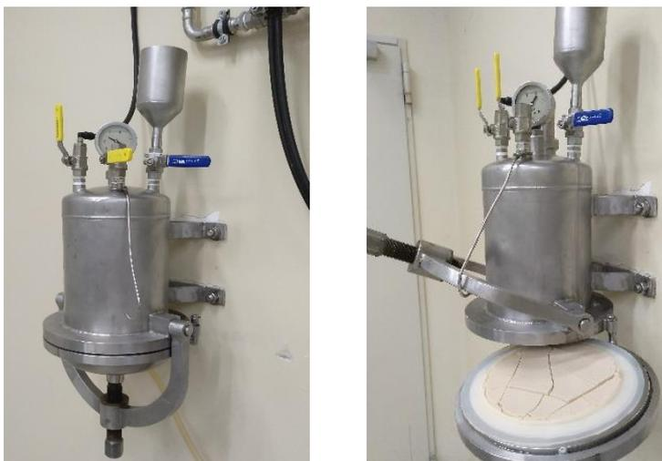
Figura 8. Equipo DCL cerrado (izqda.) y con torta de levadura (drcha.)
