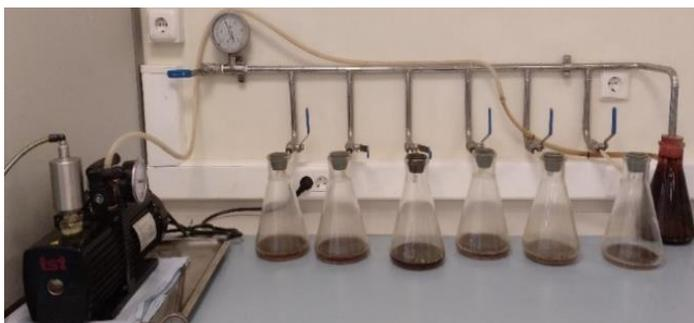
Figura 3. Sistema de filtración a vacío con varios matraces kitasatos
