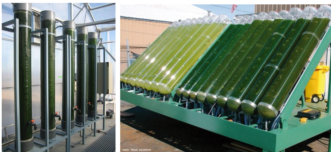
Figura A3.4. Fotobiorreactores de columna verticales e inclinados [Fuente: Plataforma tecnológica de experimentación con microalgas ALGAENERGY, Madrid]
