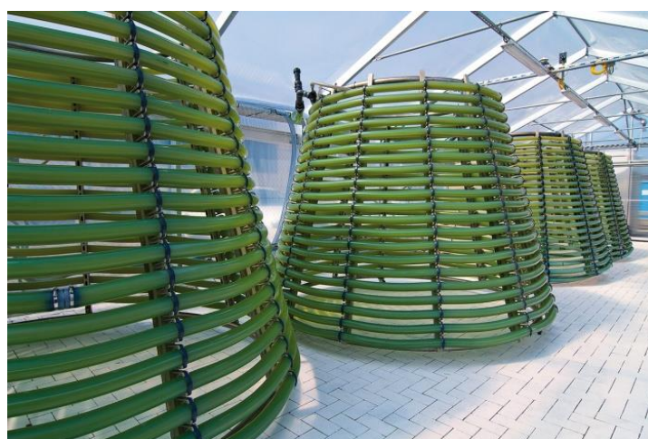
Figura A3.7. Fotobiorreactor tubular helicoidal [Fuente: GICON – GroßmannIngenieurConsultGmbH, Alemania]
