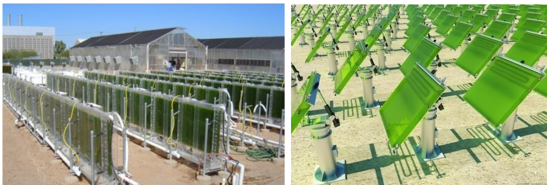
Figura A3.8. Fotobiorreactores de superficie plana [Fuente: BIOS-FIN Systemde Charles Lee, en BiosDesignCollective blog online]
