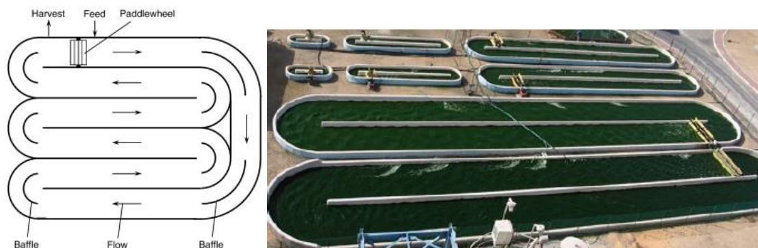
Figura A3.3. Raceway con estructura en canales
