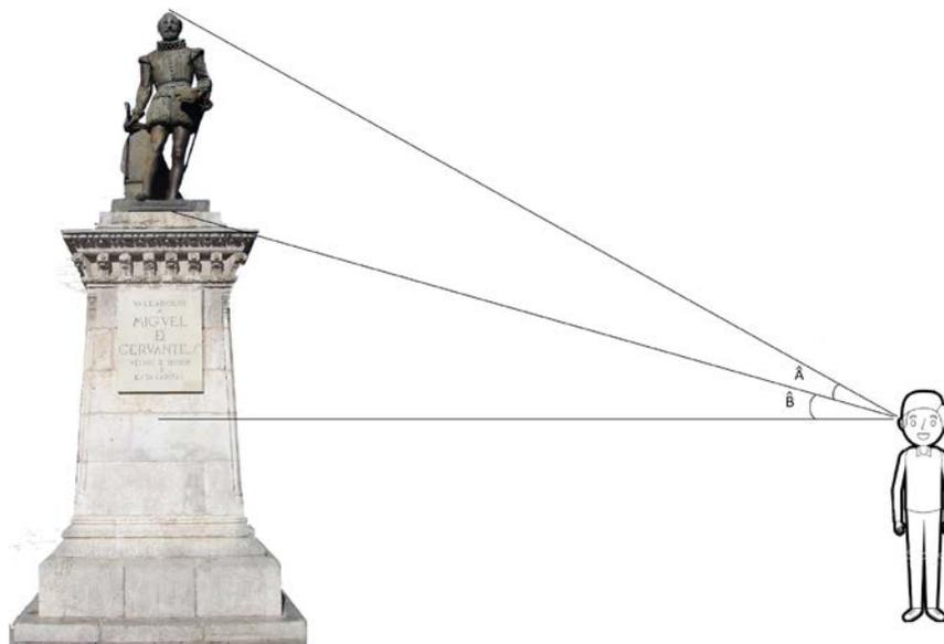
*Figura 3: Trigonometría para calcular distancias.*
