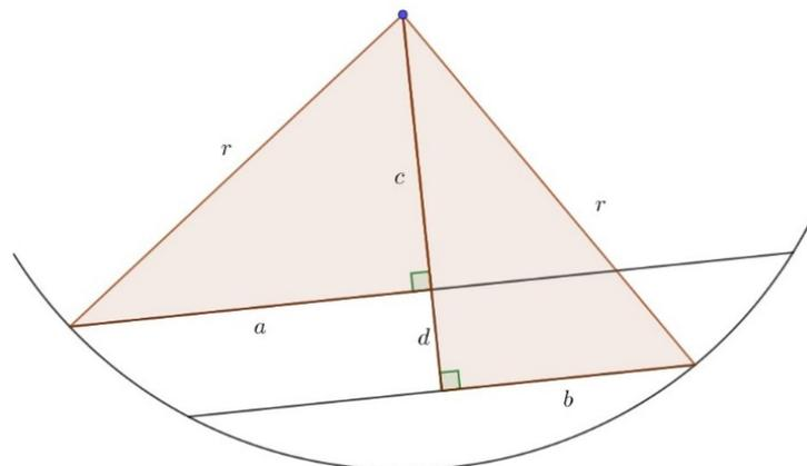
*Figura 36: Método de dos cuerdas paralelas*
