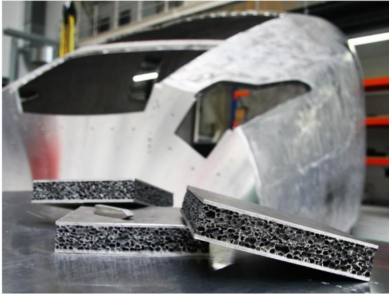
Fig. 4.2. Morro de tren de alta velocidad fabricado en espuma de aluminio.
