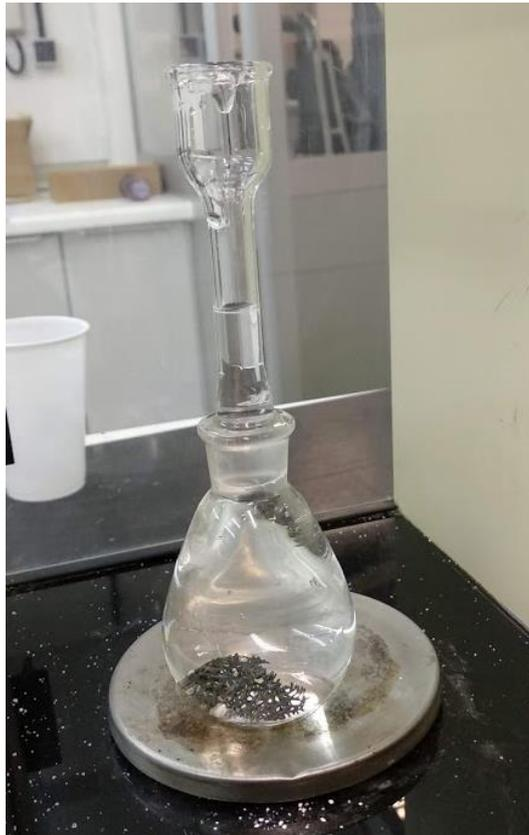
Fig. 8.17. Picnómetro de cristal empleado para la determinación de la densidad.
