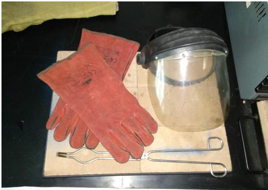
**Fig. 8.19.** Equipos de Protección Individual empleados para la manipulación del horno: Guantes térmicos, máscara protectora y pinzas.
