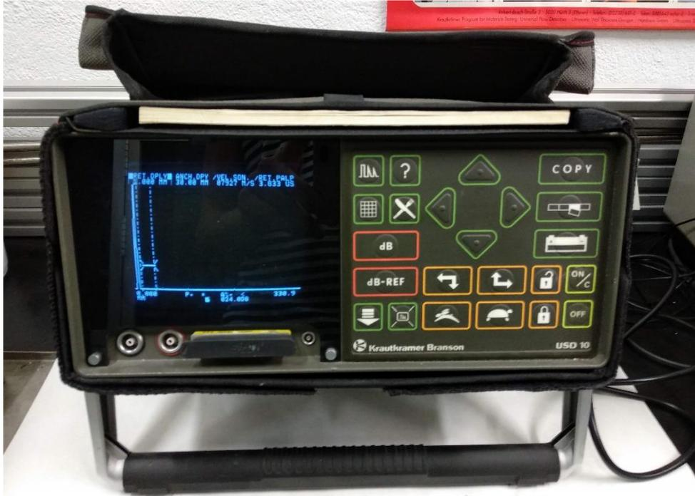
**Fig. 8.11.** Equipo empleado para los ensayos de mediciones por ultrasonidos. Equipo *USD 10* de *Krautkammer Branson*.
