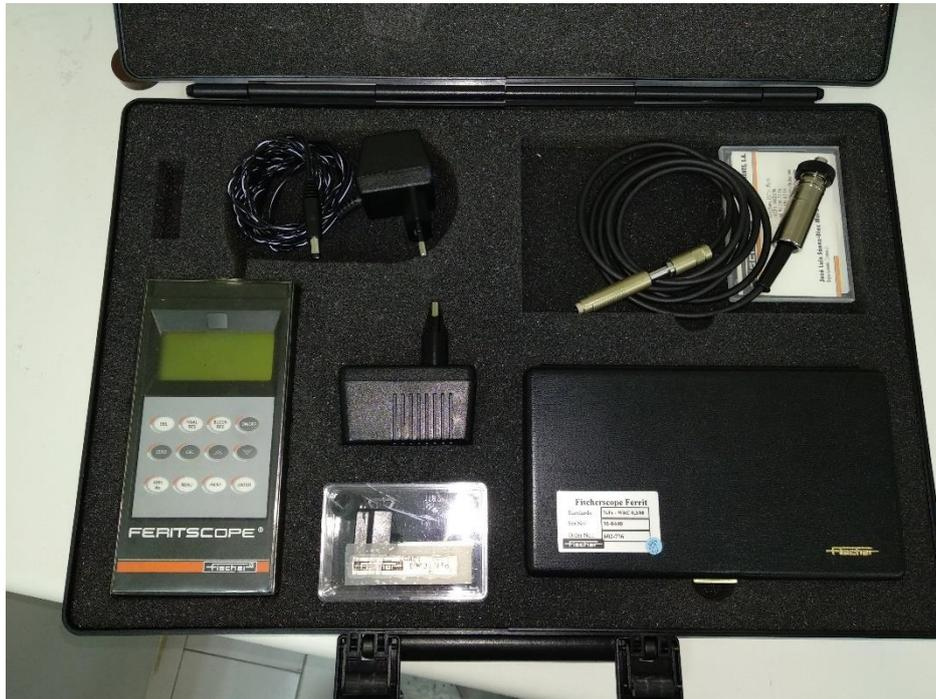
Fig. 8.3. Magnetómetro empleado en la caracterización de las espumas.
