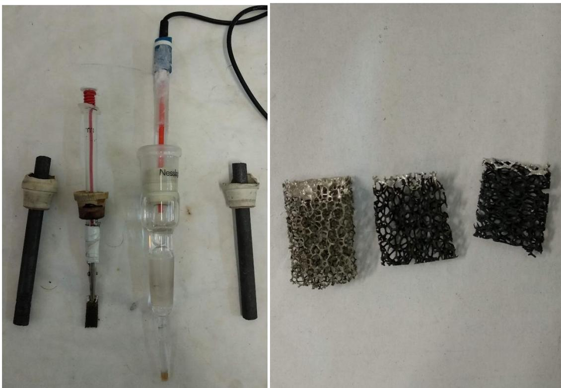
**Fig. 8.21.** Imagen izquierda muestra los electrodos empleados en el ensayo EIS. La imagen derecha muestra las probetas preparadas para el ensayo, tras la aplicación del lacado de plata.
