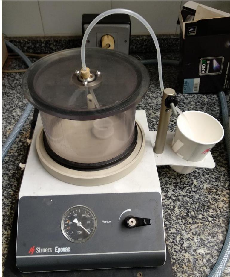
**Fig. 8.4.** Equipo de generación de vacío *EpoVac*.
