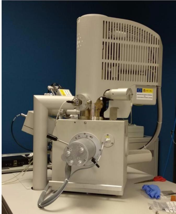
**Fig. 8.2.** Microscopio Electrónico Barrido ESEM (QUANTA 200 FEG)
