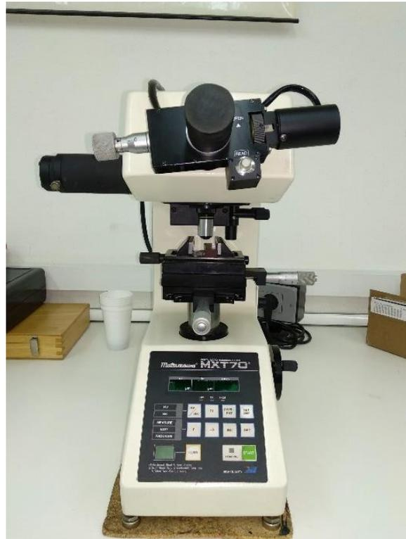
**Fig. 8.14.** Equipo de medición de microdureza Matsuzawa MXT70.
