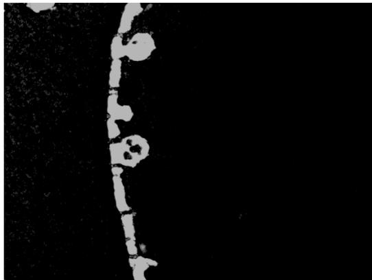
**Fig. 9.1.2.** Muestra de espuma NiCrAl 2000 tras ataque mediante agua regia. Imagen a 100 aumentos.
