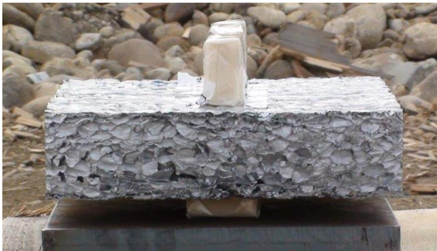
**Fig. 4.3.** Imagen de espuma de aluminio momentos antes de ser sometida a un test para comprobar su comportamiento ante una explosión controlada.
