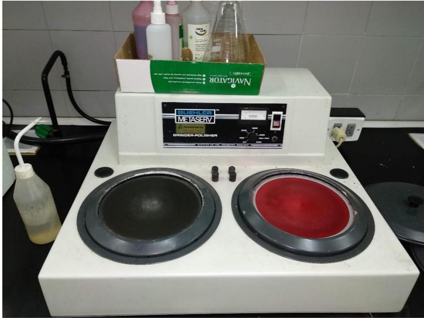
Fig. 8.7. Discos para el pulido de probetas empastilladas.
