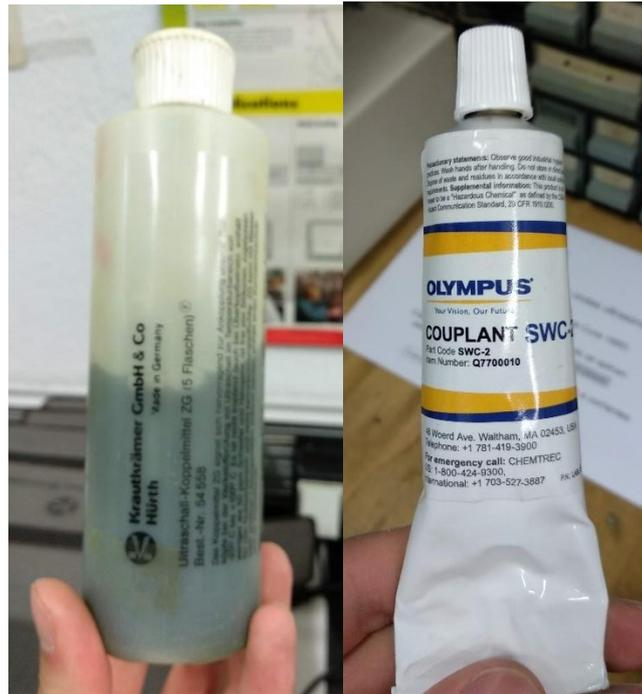
**Fig. 8.12.** Acoplantes empleados en la experimentación. La foto izquierda se corresponde con el acoplante Ultrachall-Koppelmittel ZG (5 Flaschen) de Krautkramer GmbH & Co Hurth, y la derecha con el Couplant SWC-2 de Olympus.
