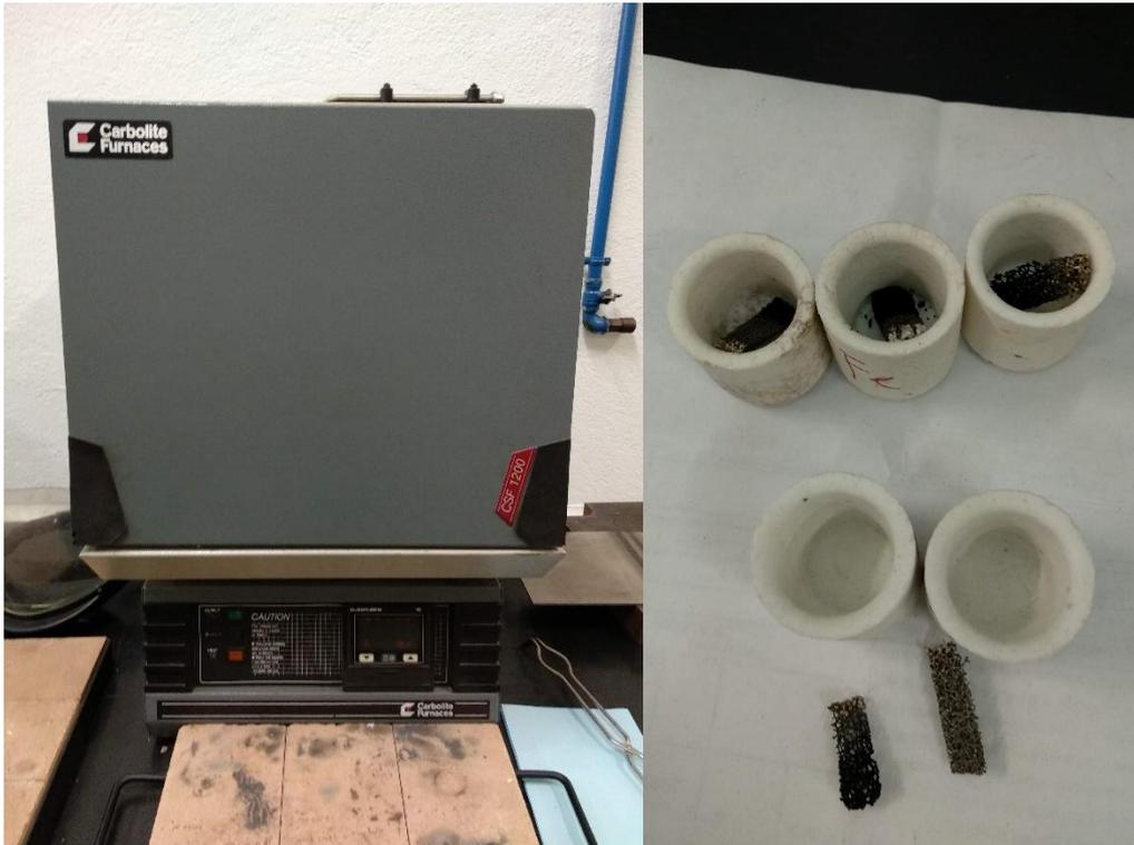
**Fig. 8.18.** La imagen derecha muestra el horno de *Carbolite Furnaces*, la derecha los crisoles y las proebtas introducidas en el horno.
