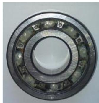
Figura 5.2 Rodamiento con fallo leve
