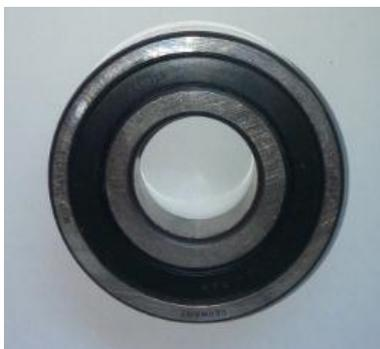
Figura 5.1 Rodamiento sano
