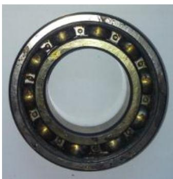
Figura 5.3 Rodamiento con fallo moderado
