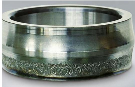
Figura 3.4 Descamación en un rodamiento [17]
