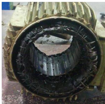
Figura 3.1 Bobinas de motor de inducción quemadas [Elaboración propia]
