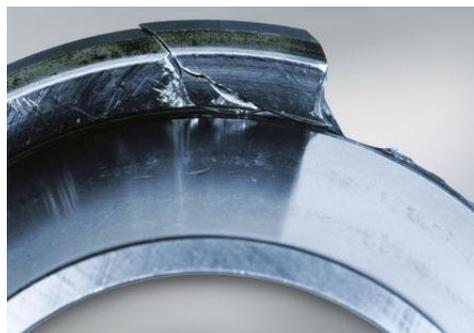
**Figura 3.3 Rotura pista interior rodamiento por fatiga [17]**
