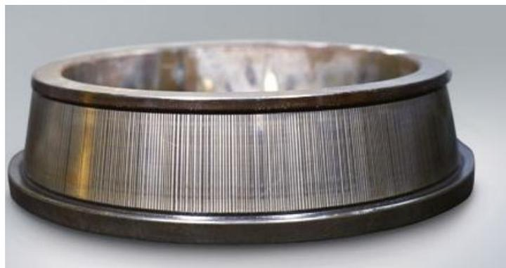
Figura 3.5 Rayado de la pista de un rodamiento debido al paso de corriente [17]
