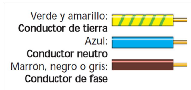
ILUSTRACIÓN 8: COLORES DE LOS CONDUCTORES
